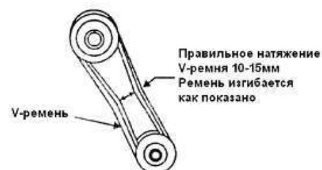
Рис. 2 Натяжение V-ремня
